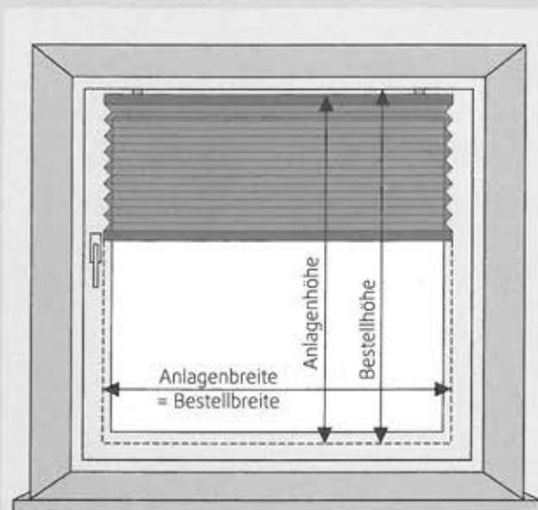
**Hinweis:** Bei der Montage mit Klemmträgern ist die **Bestellhöhe = Fensterflügelhöhe**.
